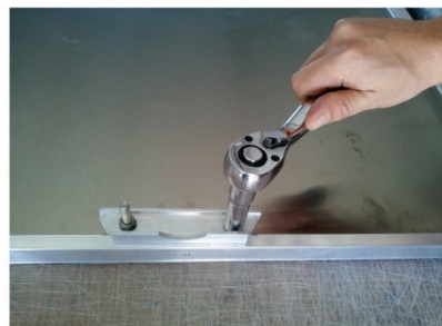
2. Matici zategnemo do ustrezne moči zatega z momentnim ključem. Moč zatega je 18 Nm.
