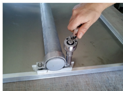
4. Matici zategnemo do ustrezne moči zatega z momentnim ključem. Moč zatega je 18 Nm.
