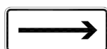
4105-1 Smer med znakom in objektom, prostorom ali delom ceste, na katerega se znak nanaša
