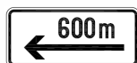
4104 Smer in razdalja med znakoma in objektom, prostorom ali delom ceste, na katerega se znak nanaša
