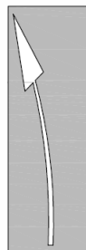
5442 Smer prometnega pasu (levo) v razcepih avtocest in hitrih cest, dolžina puščice 10,0 m
