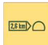
5512 Smer in dolžina izhoda iz predora, označba na steni predora
