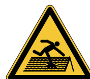
W036 Nevarnost udara, krhki strešniki
