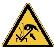
W031 Nevarnost poškodovanja roke med obdelovancem in stikalnico
