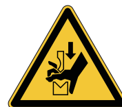
W030 Nevarnost poškodovanja roke
