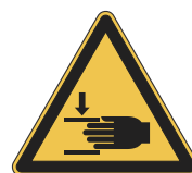
W024 Nevarnost poškodbe, stisk roke
